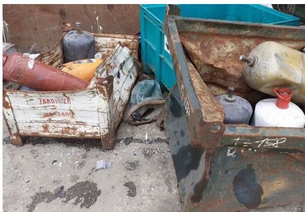
Stockage de liquides inflammables à proximité de la zone de découpage au chalumeau
