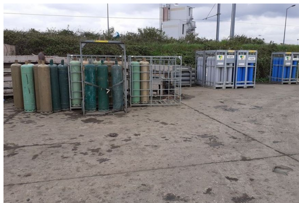
Stockage de liquides inflammables à proximité de la zone de découpage au chalumeau
